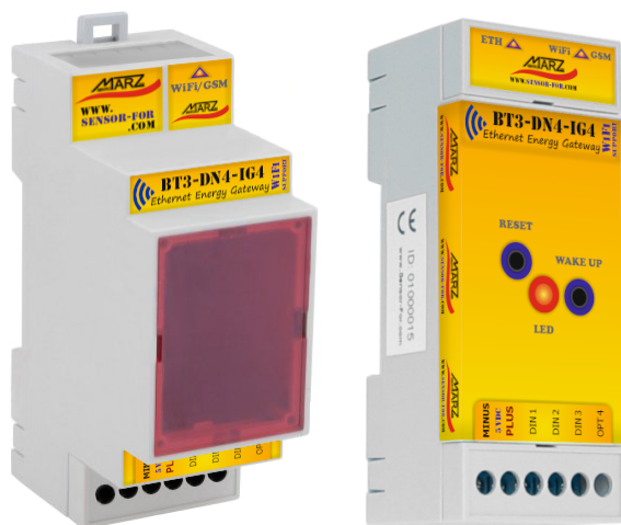
Obr. 1 4-kanálový integrátor impulsů BT3-IG4 je součástí brány BT3-DN4 označené jako BT3-DN4-IG4 (standardní a snížená verze)
