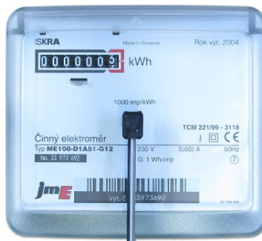
Obr. 1 Modul impulsního výstupu PU1-EH1 osazený na elektroměru s impulsní LED
