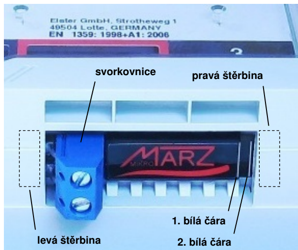
Obr. 2 Popis vkládání modulu do plynoměru BK-Gx
