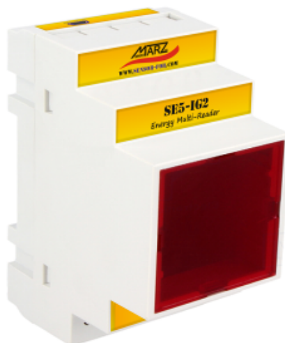
Obr. 1 5-kanálový 2-tarifní integrátor impulsů SE5-IG2
