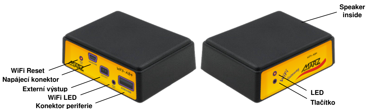
Obr. 2 WF3-AB4, popis zadní a přední strany
