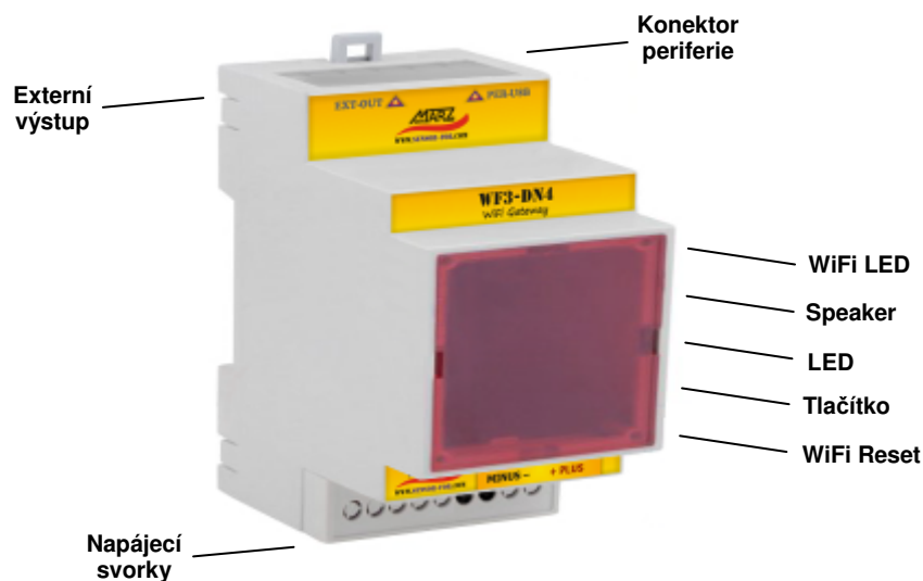
Obr. 2 WF3-DN4, popis zadní a přední strany
