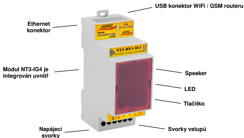
Obr. 2 NT3-DN4-IG4, popis zadní a přední strany
