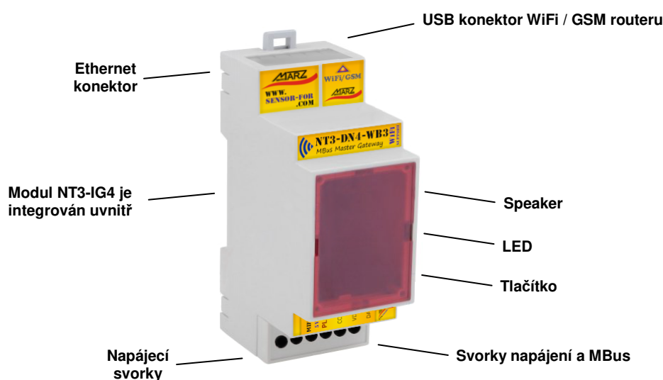
Obr. 2 NT3-DN4-WB3, popis zadní a přední strany
