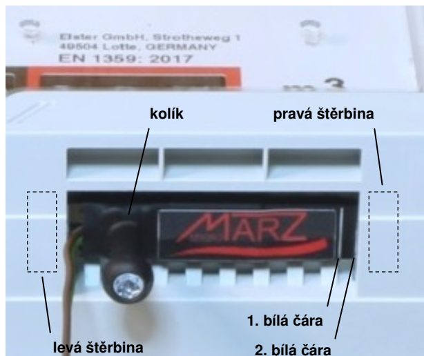
Obr. 2 Popis vkládání modulu do plynoměru BK-Gx
