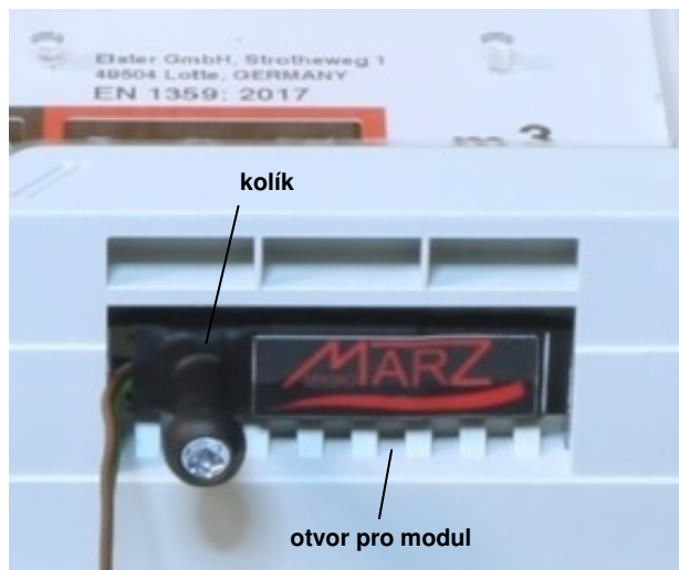
Obr. 2 Popis vkládání modulu do plynoměru BK-Gx
