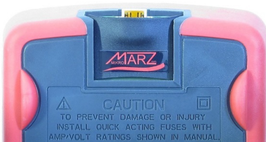
Obr. 1 Komunikační modul PU2-UT1 připojený k multimetru UT61E
